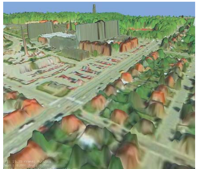
Figur 1: En laserscannet model over Aalborg med luftfoto draperet henover. Det visuelle udtryk bliver let udtværet når man kommer tæt på bygningerne.
